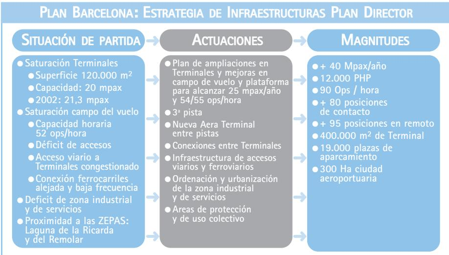
Las actuaciones previstas contemplan, a corto plazo, la adecuación de las instalaciones, tanto de lado tierra como de lado aire y la construcción, a medio plazo, de un nuevo edificio terminal, una nueva pista y nueva plataforma de estacionamiento de aeronaves.
